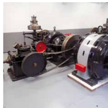
L'ancien régulateur de watts mécanique remplacé aujourd'hui par un système électronique dans le tableau de commande.
